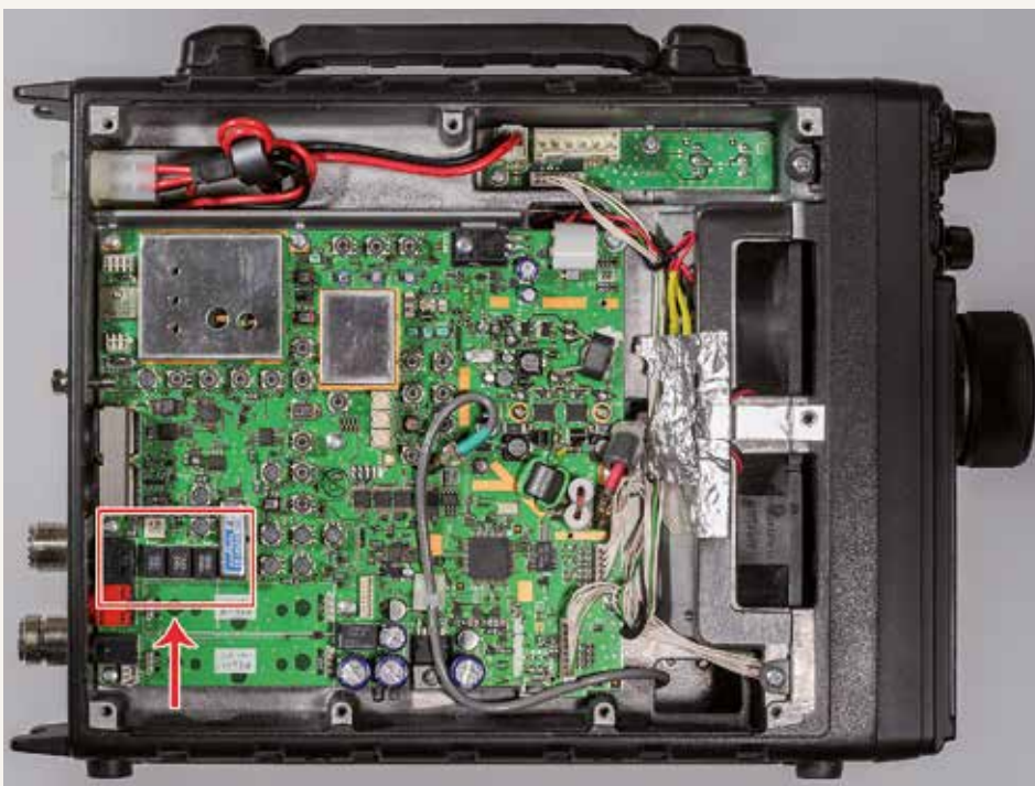
Afb. 1 Bovenaanzicht van de hoofdprintplaat
