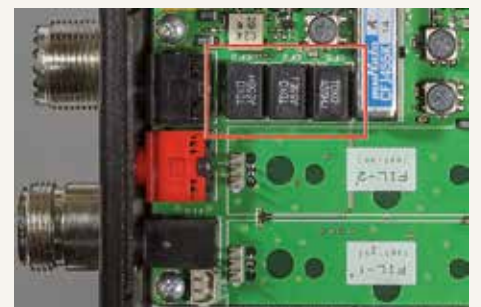
Afb. 2 Detailopname van de drie keramische filters
