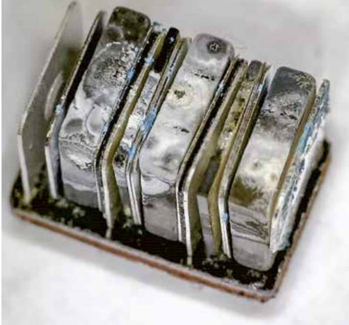
Afb. 3 Binnenzijde van een aangetast keramisch filter
